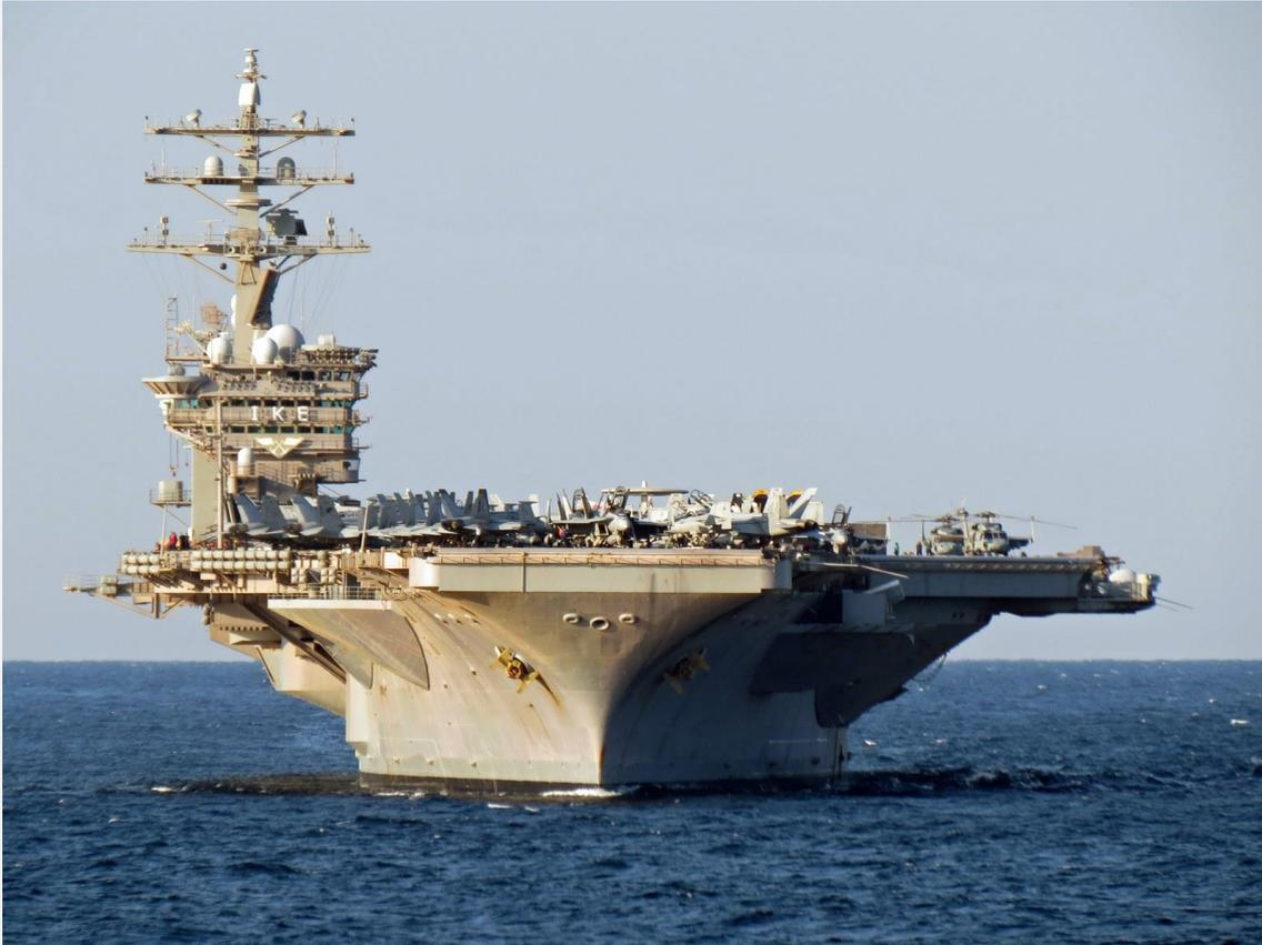
**El "Eisenhower" en la mar en octubre de 2012; la imagen, obtenida desde la prolongación de su línea de crujía y al nivel de la cubierta de vuelo, permite apreciar la sección transversal de la obra muerta y su descomunal manga. (Foto USN- Thomas L Epps)**
